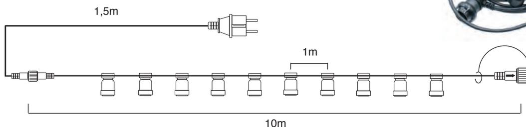
**ATTENZIONE:** il grado di protezione dei PTL potrebbe far deperire la vita dell'elettronica contenuta all'interno della virola delle lampade FiloLED causa la poca dissipazione quindi raccomandiamo di utilizzare lampade FiloLED con potenza uguale o inferiore a 3W. Termoplastiche max 9W.
