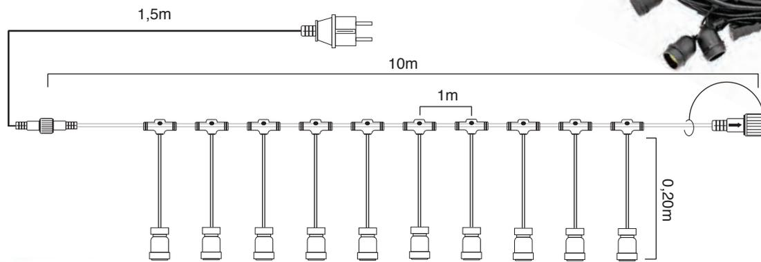
**ATTENZIONE:** il grado di protezione dei PTL potrebbe far deperire la vita dell'elettronica contenuta all'interno della virola delle lampade FiloLED causa la poca dissipazione quindi raccomandiamo di utilizzare lampade FiloLED con potenza uguale o inferiore a 3W. Termoplastiche max 9W.
